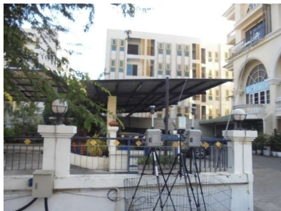
ติดตั้งเครื่องตรวจวัดฝุ่นละออง แบบ Gravimetric method เครื่องตรวจวัดเสียง ที่โรงเรียนกายอุปกรณ์สิรินธร
