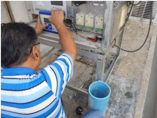
ติดตั้งเครื่องตรวจวัดฝุ่นละออง แบบ Gravimetric method ก้าวชมลพิษภายในพื้นที่โครงการ CO , NO 2 , SO 2 , THC เครื่องตรวจวัดเสียง และเครื่องวัดแรงสั่นสะเทือน ย้ายไปตามจุดที่มีการทำเสาเข็ม ภายในพื้นที่โครงการ เก็บตัวอย่างน้ำทิ้งก่อนระบายออกสู่ท่อระบายน้ำสาธารณะ
