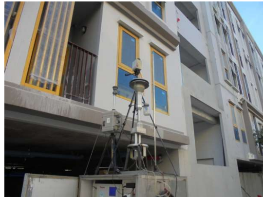
ติดตั้งเครื่องตรวจวัดฝุ่นละออง แบบ Gravimetric method ก้าวชมลพิษภายในพื้นที่โครงการ CO , NO 2 , SO 2 , THC เครื่องตรวจวัดเสียง และเครื่องวัดแรงสั่นสะเทือน ย้ายไปตามจุดที่มีการทำเสาเข็ม ภายในพื้นที่โครงการ เก็บตัวอย่างน้ำทิ้งก่อนระบายออกสู่ท่อระบายน้ำสาธารณะ
